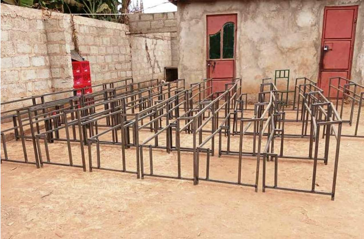
Abbildung 18: Schulbänke als Holz-Metall-Konstruktion werden vor Ort produziert (3. Teilprojekt)
